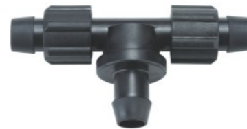
货号No.:56216BTS(600) 适用水压 1.5-3.5Kpa 流量 600L/H φ16带用稳流旁三通 φ16 Off take tee (Pressure compensating)
